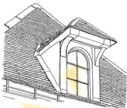
Lucarne "à capucine" (3 pans de toiture) en auvent. Il convient de préserver ce patrimoine rural, mémoire de nos greniers à foin.
